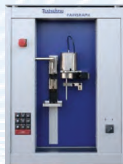
Fig. 65. Modul pentru determinarea rezistentei la tractiune a fibrelor textile (Firma producatoare Textechno din Germania)
