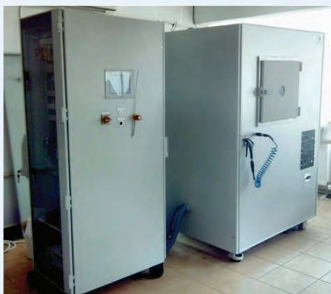
Fig. 69. Instalatie de plasma tip 400 CD roll-to-roll (Firma producatoare Europlasma din Belgia)
