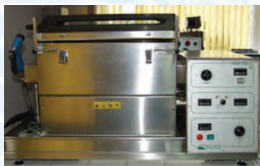
Jigher automat (latime 500 mm) pentru pregatirea si vopsirea materialelor textile in foaie lata
