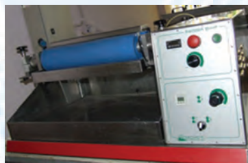
Fulard cu doua valturi oscilante vertical/orizontal (model BVHP 500/100) pentru impregnarea materialelor textile cu substante polimerice si de functionalizare
