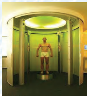
Fig. 68. Sistem mobil de masurare 3D automata a corpului (Firma producatoare Human Solutions GmbH din Germania)
