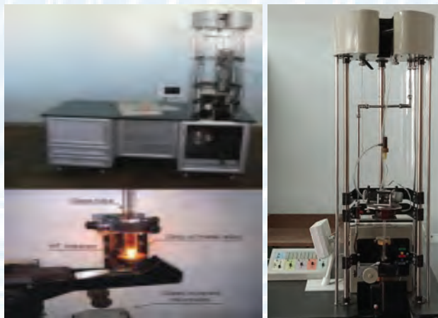
Fig. 56. - Echipament pentru obtinerea de microfilament din topitura de aliaje
