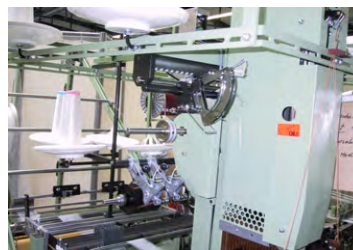
Masina de tesut NF SPEZIAL pentru produse medicale cu geometrie variabila (structuri liniare si "Y")
