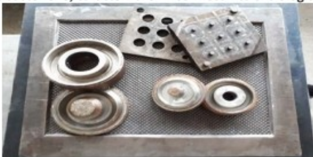
Fig. 15. Matrite pentru garnituri de etansare si dopuri
