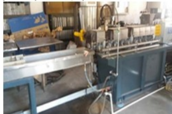
Extruder granulator dublu snec cu corotatie tip TSE 35
