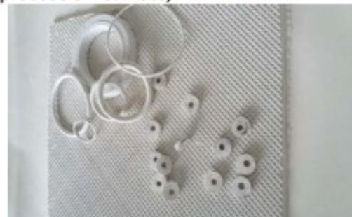
Fig. 16. Produse finite fabricate prin compresie din nanocompozite antibacteriene: garnituri de etansare si dopuri
